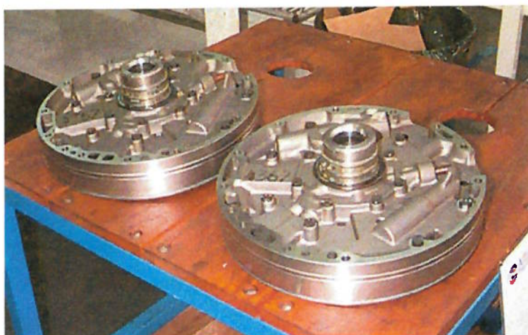
Figura 15 - Bombas de óleo e suporte frontal.
