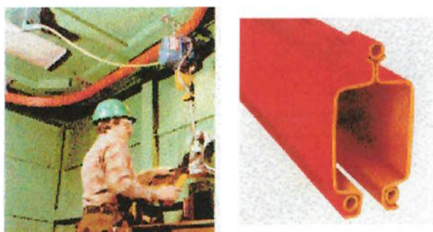
Figura 27 - Exemplo de Sistema KBK e perfil do trilho.
